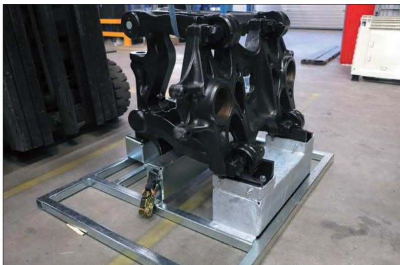
Un support fabriqué entièrement en acier pour une pièce d'un engin agricole. Le support est adapté pour être utilisé en combinaison avec une Smartbox.
