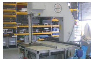
Notre plus grande scie à ruban peut découper 1400 mm.
