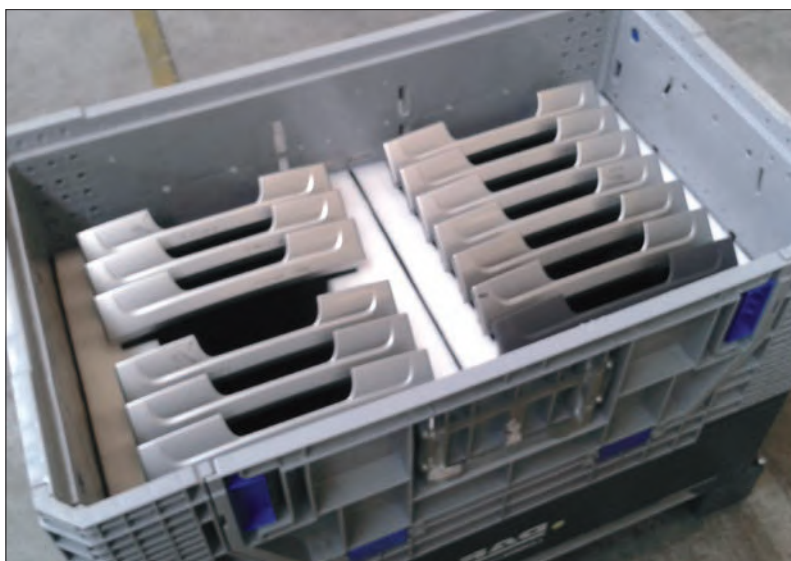
Inserts en polypropylène alvéolaire combinés à de la mousse pour élément intérieur de cabine de camion.
