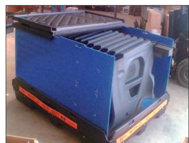
Caisse-palette avec parois démontables et un calage en mousse pour des pièces automobiles.
