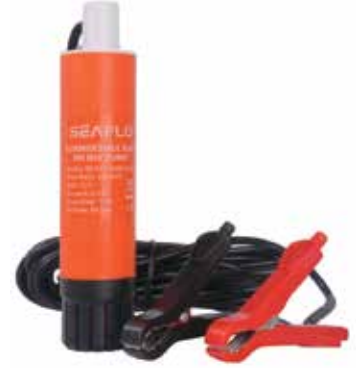
SR09521 Seaflo Su ve Yakıt Pompası 12 V Maşalı - 500 Gph Kablo: 5 Metre, Hortum Çıkışı: 3/4", Basınç: 5 Mt
