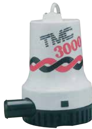
SR12120 TMC Sintine Pompası 3000 gph. 12 V 18 A SR12122 TMC Sintine Pompası 3000 gph. 24 V 9 A Hortum çıkışı: Ø:32 mm
