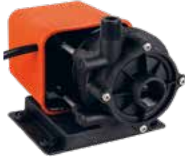
SR09713 Seaflo Klima Pompası 500 gph 220 V 50 Hz, 31 Lpm, 4,3 m, 105 W, 09 Amper Giriş: 3/4" FPT Çıkış: 1/2" MPT
