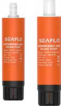
SR09517 Seaflo Su ve Yakıt Pompası 12 V - 200 Gph Ölçüler :Ø 38 mm Boy: 135 mm Çıkış: 10 mm SR09518 Seaflo Su ve Yakıt Pompası 12 V - 280 Gph Ölçüler :Ø 41 mm Boy: 175 mm Çıkış: 13 mm SR09520 Seaflo Su ve Yakıt Pompası 12 V - 500 Gph Ölçüler :Ø 41 mm Boy: 180 mm Çıkış: 20 mm
