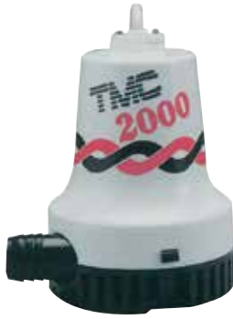
SR12112 TMC Sintine Pompası 2000 gph. 12 V 10 A SR12114 TMC Sintine Pompası 2000 gph. 24 V 5 A Hortum çıkışı: Ø:29 mm
