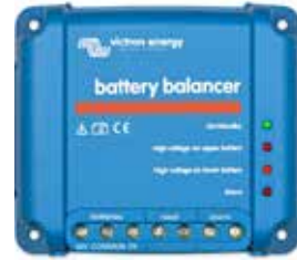
SR14814 Akü Şarj Dengeleyicisi 12 V Akülerine Bağlı Olan 2 Serinin Şarj Durumunu ve Paralel Bağlı Olan Şarj Serisini Eşitler
