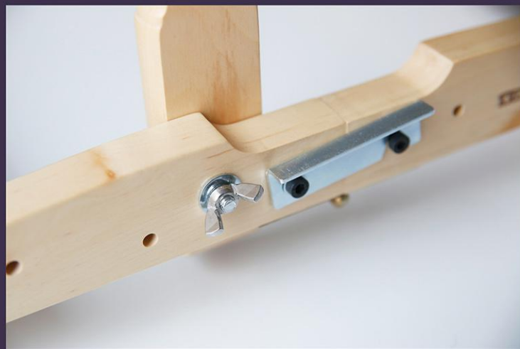
Przed przykręceniu nakrętki skrzydełkowej umieść małą metalową podkładkę.
