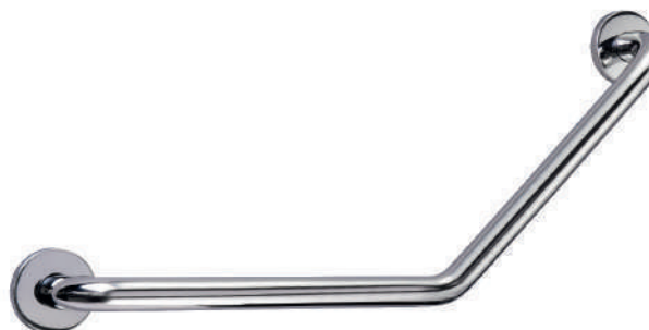
BARRE D'APPUI COUDÉE À 135° 40 X 40 CM - Ø 32 MM Inox 304 épaisseur 1,5 mm. 2 points de fixations. Charge maximale 150 kg.
