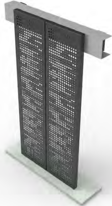
SOBRE PERFIL Y ANCLADO A LOSA
