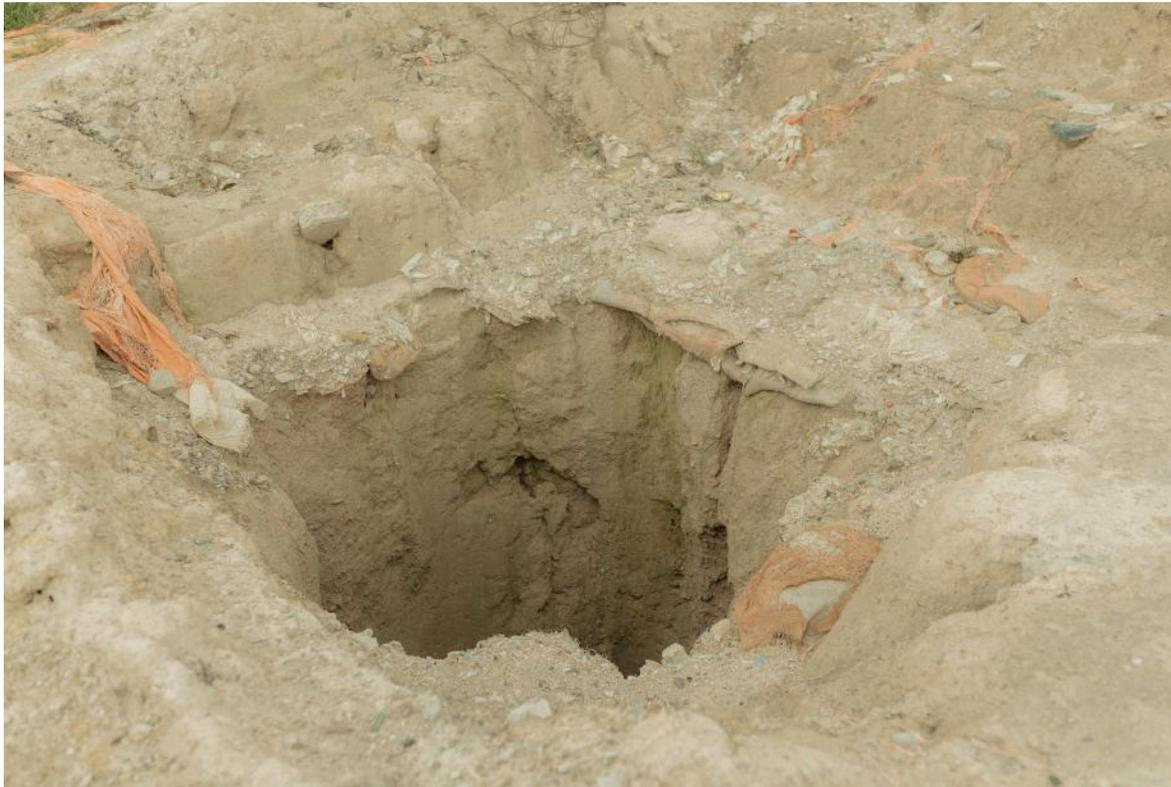
Les puits se poursuivent aussi parfois à l'horizontale. Les ressources étant limitées pour sécuriser correctement ces puits, certains d'entre eux présentent un risque élevé d'effondrement, piégeant les personnes à l'intérieur et provoquant des accidents mortels.
