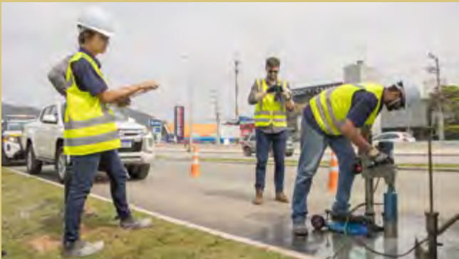
Equipe do Laboratório de Obras Rodoviárias coleta amostras de pavimentação para análise
