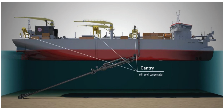
Figura 3 – Representação esquemática de uma draga autotransportadora TSHD, principal equipamento utilizado na alimentação artificial de praias 8
