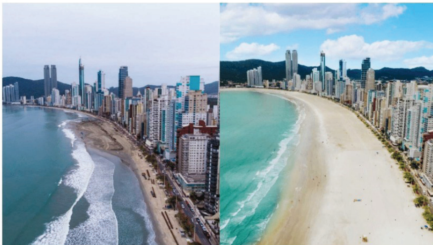
Obra aumentou a largura da faixa de areia de 25 para 70 metros de extensão Imagem: Divulgação/Prefeitura de Balneário Camboriú
