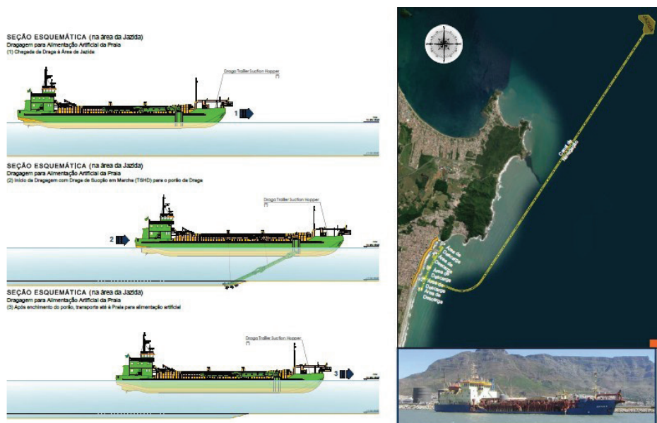
Figura 4 – Imagem extraída do projeto de alimentação artificial da Praia do Gravatá, que ilustra o procedimento de extração do material da jazida subaquática pela draga hopper
