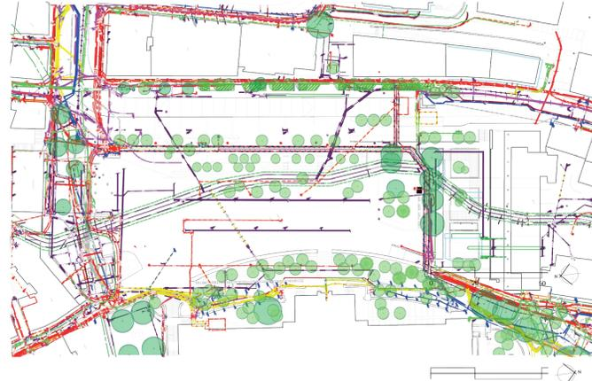
**PLAN REPRÉSENTATION DES PLANTATIONS AVEC LES CANALISATIONS** | Le plan ci-dessus propose une première série de dévoiement, compatible avec le projet d'aménagement. L'arrosage sera alimenté depuis les réseaux d'eau potable existant. L'alimentation pour les forains maintenus depuis les réseaux existants.
