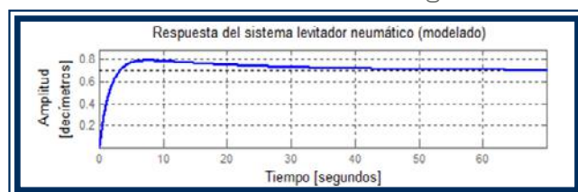
Fig. 7. Respuesta del sistema levitador neumático, ante una entrada de tipo escalón unitario
