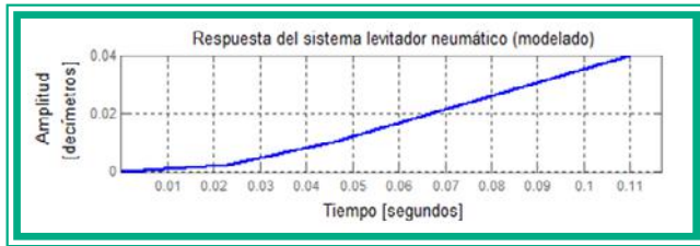
Fig. 8. Acercamiento a la respuesta del sistema levitador neumático, ante una entrada de tipo escalón unitario
