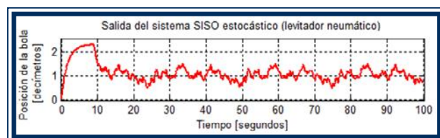
Fig. 3. Señal de salida del sistema SISO estocástico (levitador neumático).
