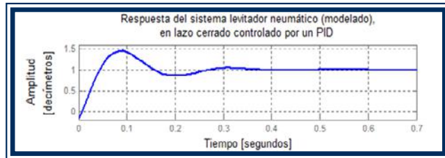
Fig. 9. Respuesta del sistema levitador neumático (modelado) en lazo cerrado controlado por un PID.
