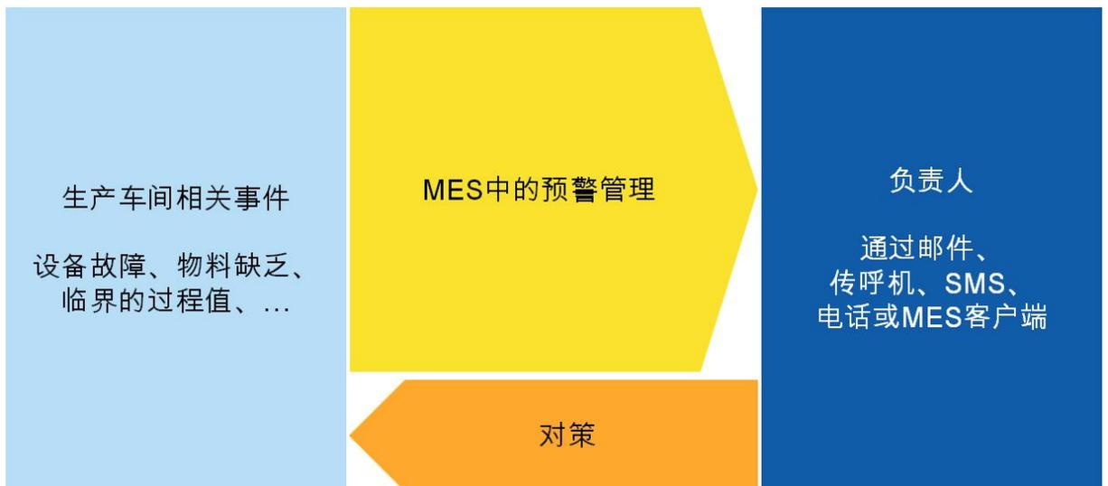
图3：MES中集成的预警管理通知员工生产上的重要事件
