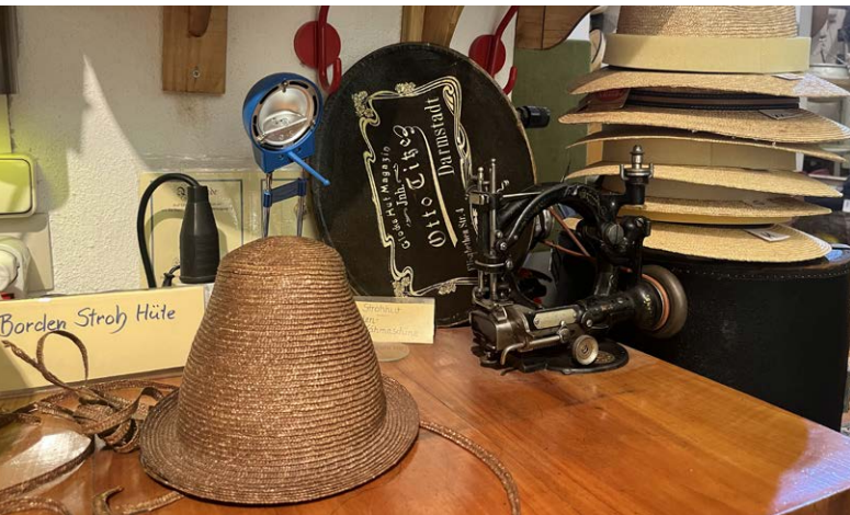
DIESE NÄHMASCHINE IST SPEZIALISIERT AUF STROHHÜTE. FOTOS: MAREN ZIMMERMANN
