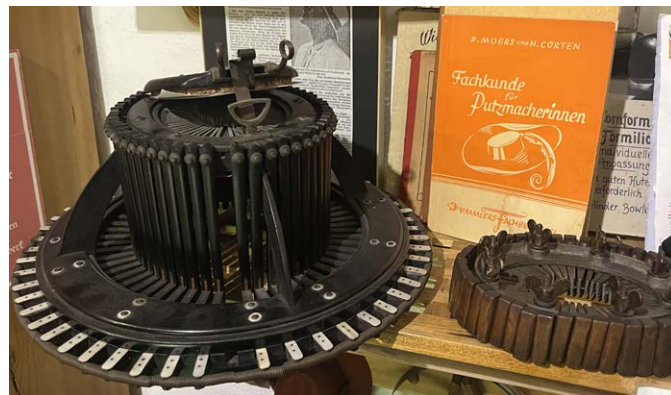
DIESE NÄHMASCHINE IST SPEZIALISIERT AUF STROHHÜTE. FOTOS: MAREN ZIMMERMANN
