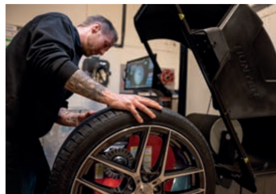
Hunter Road Force Elite med vejtryksrulle. Når hjulet afbalanceres, sikrer rullen at der samtidig testes med vejtryk og sidetræk og du får en fuld diagnose på hjulet.
