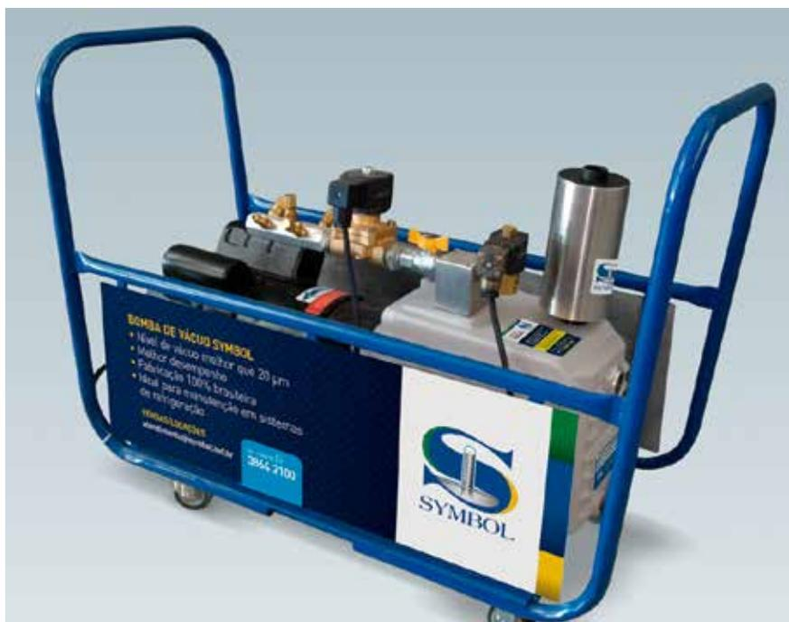
A empresa comparece com sua Bomba de Vácuo Duplo Estágio de bombeamento, vazão de 50m<sup>3</sup>/h (30 cfm). O diferencial deste equipamento é ser montado em carrinho para movimentação, possuindo kit solenoides para proteção do sistema em caso de falta de energia durante o processo de evacuação e, também, falta de conexão ao sistema com 5 entradas SAE, podendo ser acoplado a linha de alta e baixa pressão e, ao mesmo tempo, um vacuômetro para acompanhamento.
