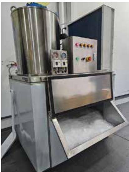
A RAC lança suas máquinas de gelo em escamas utilizando compressores Bitzer semi-herméticos em todos os modelos. Com capacidades de 1,25 a 3,0 toneladas de gelo por dia, os equipamentos são entregues completos, inclusive com reservatório e quadro elétrico, totalmente prontos para uso. O reservatório de gelo é em aço inox com isolamento em PU 50 mm mantendo o gelo por longo período. Elas possuem estrutura compacta, alta produtividade e excelente eficiência energética. As partes operativas das
