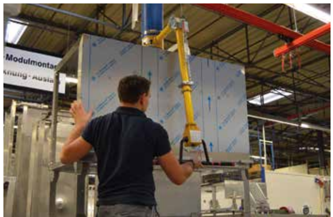
VPL160-60KG mit Bediengelenk und Verlängerung für Blechgehäuse
