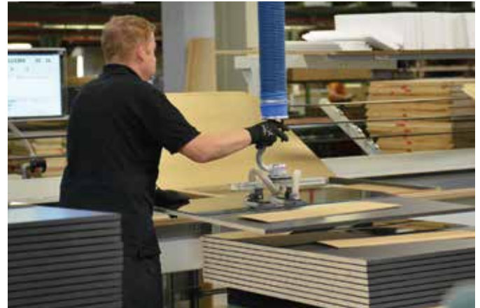
VQL100-35KG Umsetzen von beschichteten Spanplatten
