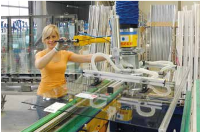
VPL160-90P-35KG mit pneumatischer Schwenkvorrichtung für Glasplatten
