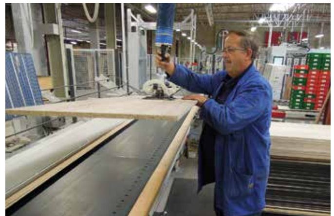
VQL100-35KG Handhabung von rohen, porösen Spanplatten
