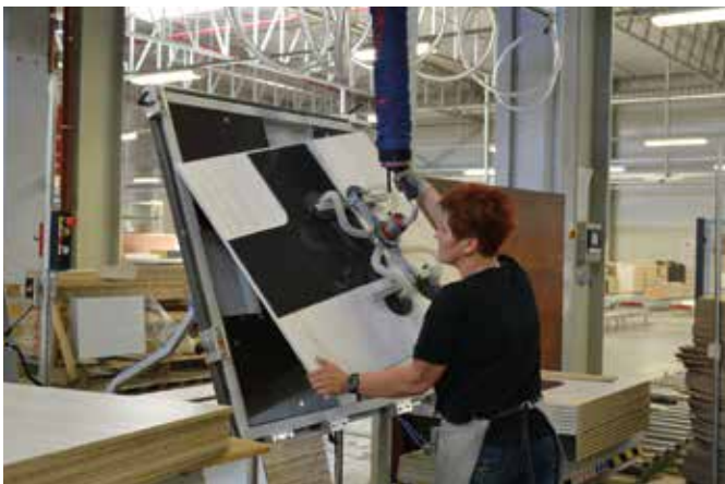
VQL100-90-25KG mit 4-fach Sauggreifer für die vertikale Aufnahme und anschließende horizontale Ablage von Holzplatten
