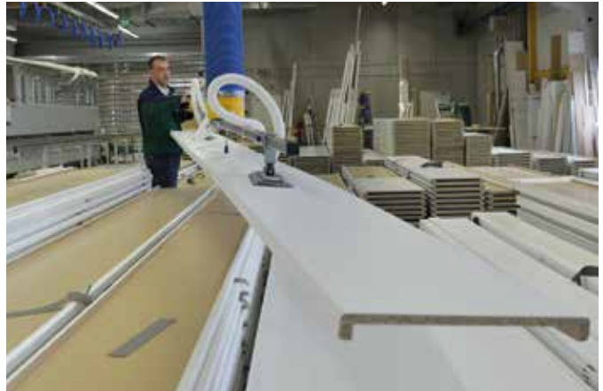
VPL200-125KG Handhabung von beschichteten Spanplatten bis 6.000 mm Länge
