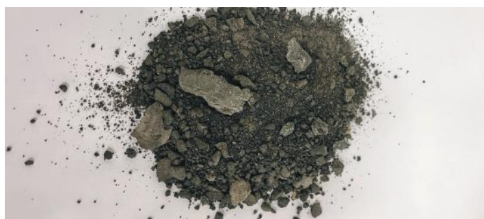
Fig. 8: Clinker modificado con cenizas de la incineración de RSU creado utilizando una adición del 1 al 2% de BA de la incineración de RSU a la alimentación del horno de cemento.
