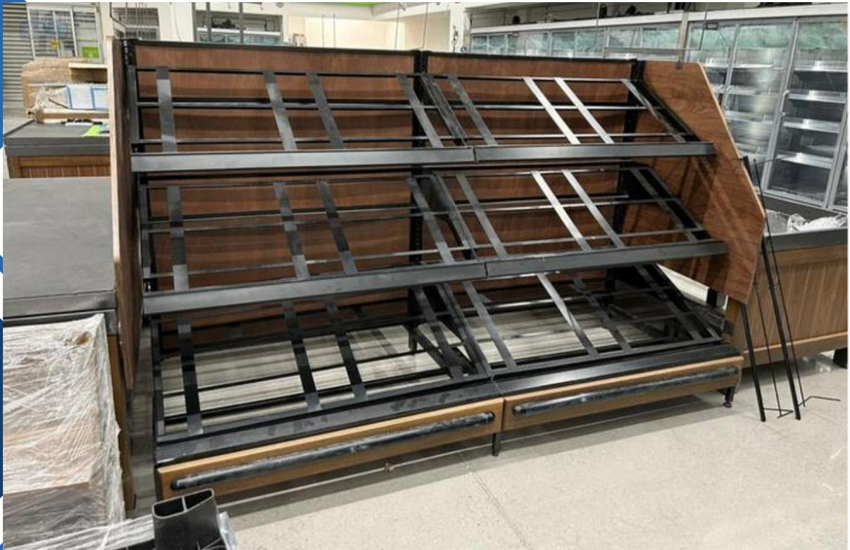
Las dimensiones se pueden ajustar según proyecto. Fabricadas en acero inoxidable o acero al carbón.
