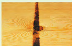
Quemadura de máquina
