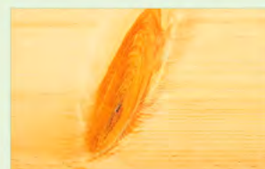
Nudo aserrado longitudinalmente
