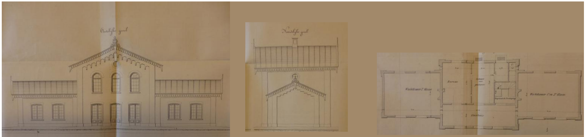
06. Vooraanzicht, zijaanzicht en plattegrond (begane grond) van het nieuwe, ruimere type 5de klasse voor Station Vught. De zijvleugels zijn verlaagd en vergroot. De vergroting bood ruimte om de aanvankelijk gedeelde wachtkamer op te splisten in een wachtkamer voor de eerste en tweede klasse en een wachtkamer voor de derde klasse. [BHIC]
