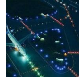
استخدام إضاءة الأرضية الخضراء في المطارات لتقليل استهلاك الوقود أثناء التاكسي (المصدر: TM3 Airports)
