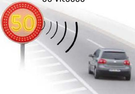
Un radar détecte l'approche d'un véhicule. La détection d'une vitesse excessive déclenche le fonctionnement du panneau.
