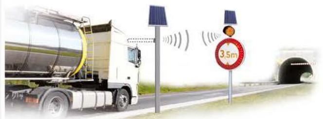
Un détecteur de gabarit est disposé sur le coté de la chaussée, en amont du panneau. Si la hauteur limite est atteinte, le renforcement lumineux sur le panneau d'indication de gabarit est activé.
