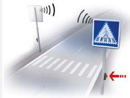
L'activation de l'appel piéton déclenche le renforcement lumineux sur les deux panneaux. Le passage piéton est alors sécurisé dans les deux sens de circulation.
