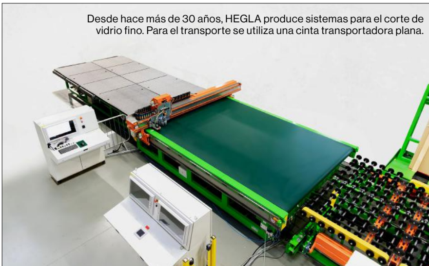
El vidrio fino mide entre 0,5 y 2 mm de grosor. Sus características lo hacen más flexible y resistente a la rotura, aunque plantea mayores requisitos a la hora de manipularlo.
