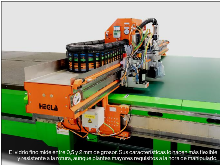
Desde hace más de 30 años, HEGLA produce sistemas para el corte de vidrio fino. Para el transporte se utiliza una cinta transportadora plana.
