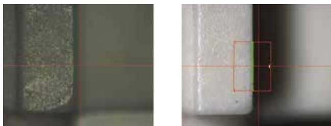
Una característica vista solo con luz coaxial.
