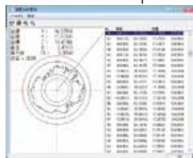
Desviación geométrica de una característica circular
