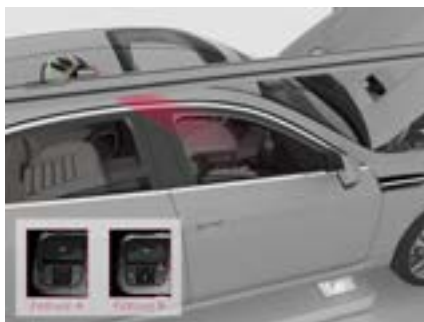
KONTROLA SPRÁVNÉHO TYPU SPÍNAČŮ NA PŘÍSTROJOVÉ DESCE
