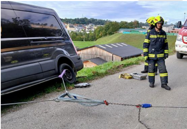
Fahrzeugsicherung, um weiteres Abrutschen zu verhindern
