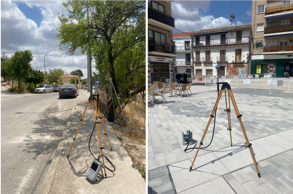
Figura 3. Analizador de espectros portátil FSH8 y antena omnidireccional TSEMF-B2 (Germany, Munich, ROHDE&SCHWARDZ).
