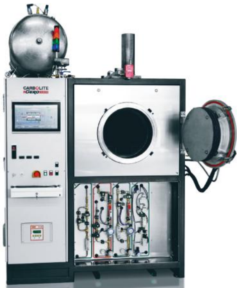
Obr. 12: Pec GLO pro tepelné odstranění pojiv pod inertním plynem, vodíkem nebo částečným tlakem s plně vybaveným bezpečnostním systémem.
