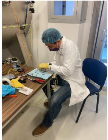
Doctor Ferrer soldando sensores Cámara Termo-vacío UAT
