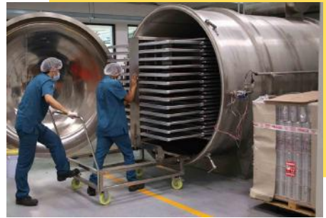
Liofilizador en CITSIA Innovación Tecnológica de Alimentos, ubicado en la Universidad Autónoma de Guadalajara (UAG).
