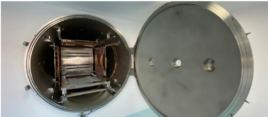
Interior cámara Termo-vacío
