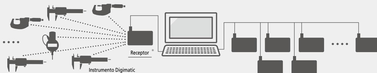
Nota: El receptor no es necesario cuando se usa con Mitutoyo Bluetooth® U-WAVE fit
