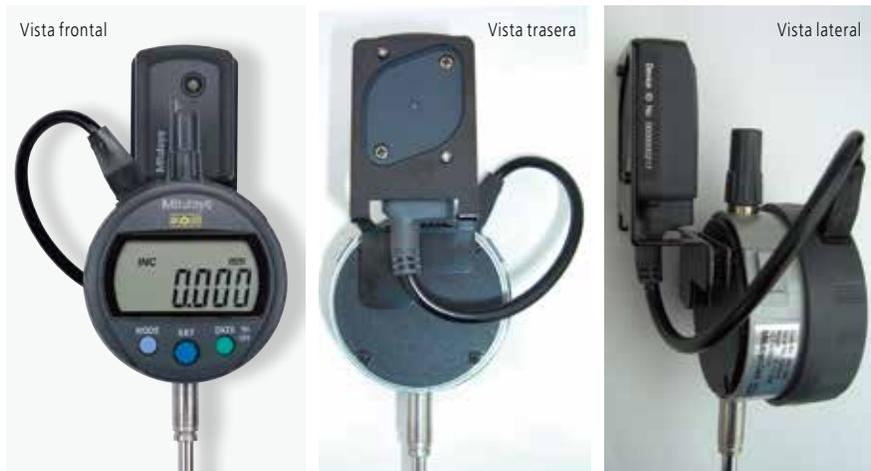
● Imagen de fijación del sujetador al instrumento principal
