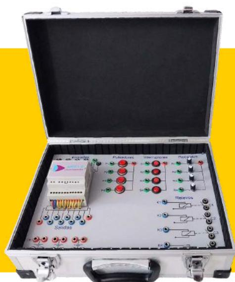
El maletín lleva un autómata microcontrolado programable (AMP1) que se conecta a varios botones, interruptores y perillas. También incluye luces y conexiones que simulan el encendido de equipos eléctricos. Todo está organizado para practicar de forma segura y entender cómo funcionan los sistemas de control automático.
