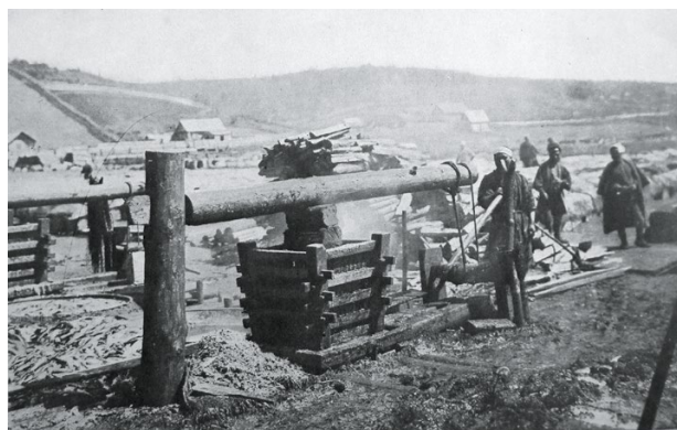
Рис. 3.5. Прессы симэ доу и сельдеварочные котлы (Шмидт, 1905)
