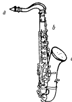
Saxofon. Părţi componente: a, muştiuc (cu ancie simplă); b, corpul instr.; c, pavilion.
