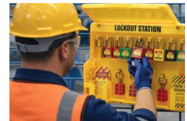
ESTACIÓN DE BLOQUEO
