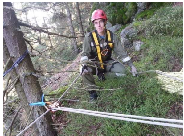
Aufbau einer Umlenkrolle zum Abseilen einer Schleifkorbtrage
