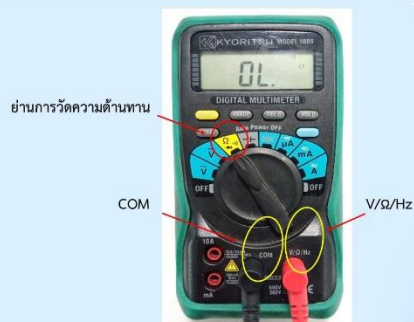
รูปที่ 1.25 การปรับสวิตช์เลือกย่านการวัดความต้านทาน ( \Omega ) ของมัลติมิเตอร์ดิจิทัล
