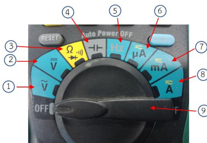
รูปที่ 1.10 สัญลักษณ์และสวิตช์เลือกเมนูการวัดค่าต่าง ๆ ของมัลติมิเตอร์ดิจิทัล
