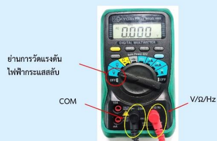
รูปที่ 1.24 การปรับสวิตช์เลือกย่านการวัดแรงดันไฟฟ้ากระแสสลับ (ACV) ของมัลติมิเตอร์ดิจิทัล
