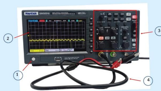
รูปที่ 1.28 ส่วนประกอบของออสซิลโลสโคป Hantek รุ่น DSO2D15
