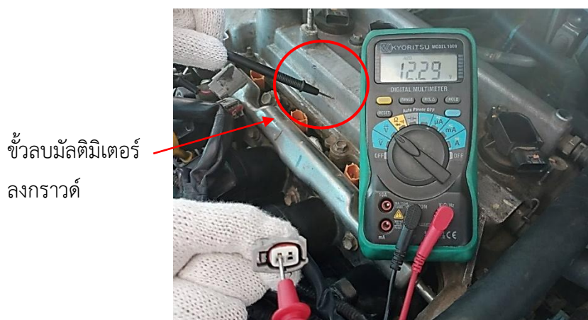
รูปที่ 1.24 การใช้มัลติมิเตอร์ดิจิทัลวัดแรงดันไฟฟ้าของอุปกรณ์ในรถยนต์ ที่มา : จิรโรจน์ เลิศชนเปี่ยมสุข. 2566
