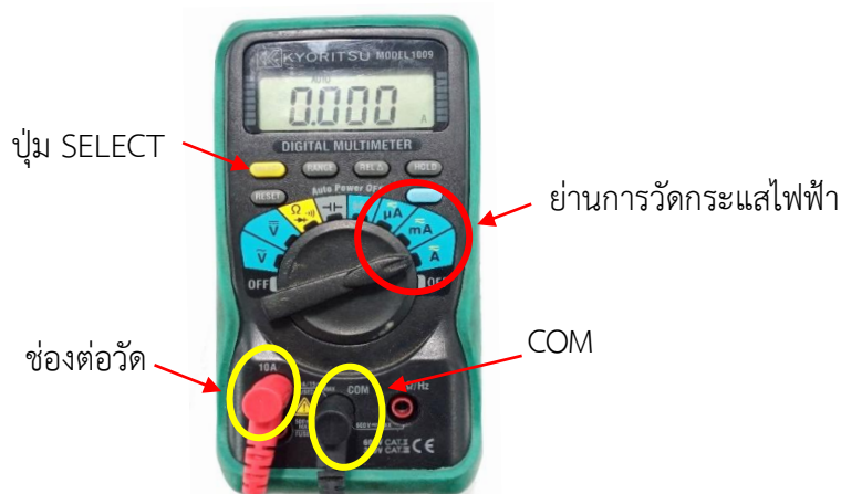
รูปที่ 1.16 ย่านการวัดกระแสไฟฟ้า (A) ของมัลติมิเตอร์ดิจิทัล
