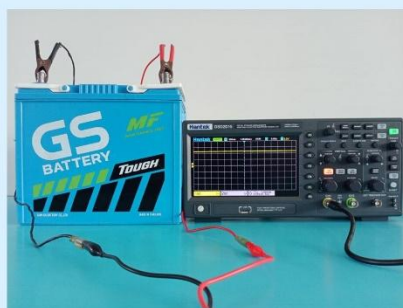
รูปที่ 1.35 การใช้ออสซิลโลสโคปวัดสัญญาณของอุปกรณ์อิเล็กทรอนิกส์ในรถยนต์
