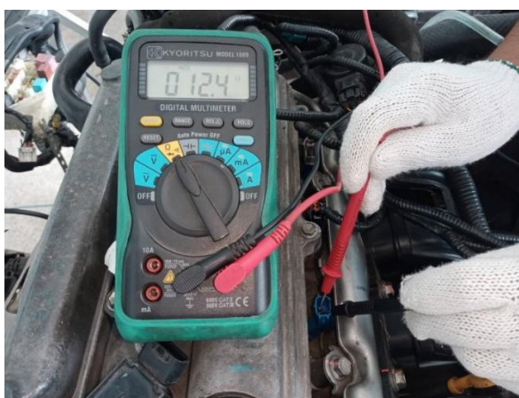
รูปที่ 1.23 การใช้มัลติมิเตอร์ดิจิทัลวัดความต้านทานของอุปกรณ์ในรถยนต์
