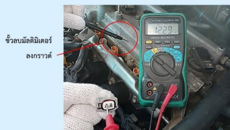
รูปที่ 1.34 การใช้มัลติมิเตอร์ดิจิทัลวัดแรงดันไฟฟ้าของอุปกรณ์ในรถยนต์
