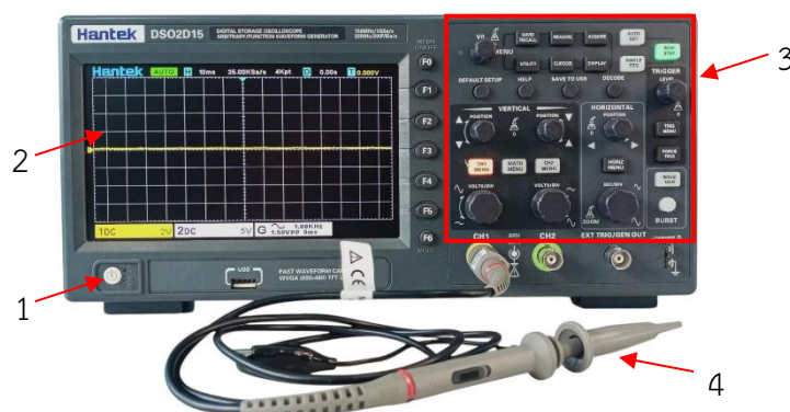
รูปที่ 1.18 ส่วนประกอบของออสซิลโลสโคป Hantek รุ่น DSO2D15
