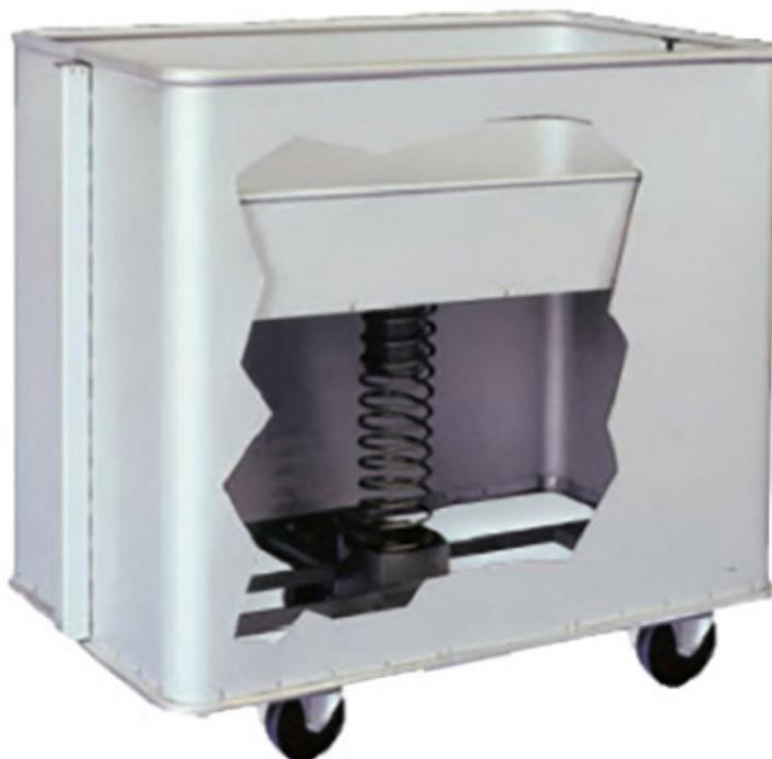
Carro con bandeja interior que se eleva a medida que disminuye la carga. Evita tener que agacharse gracias a la altura de carga constante.
