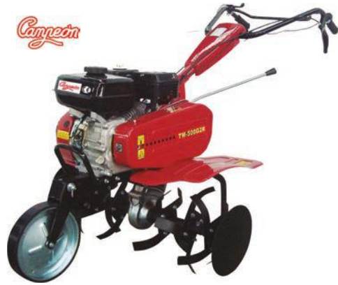
Campeon 914297 Motor ECO de 4 tiempos de 6.5 Hp y 196 cc. Ancho de trabajo 80 cm. Fresas de 24 cm cada una.
