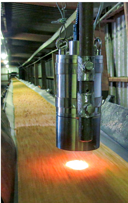
Abbildung 2: Testinstallation eines FT-NIR Sensors über einem Förderband mit Sojaschrot
