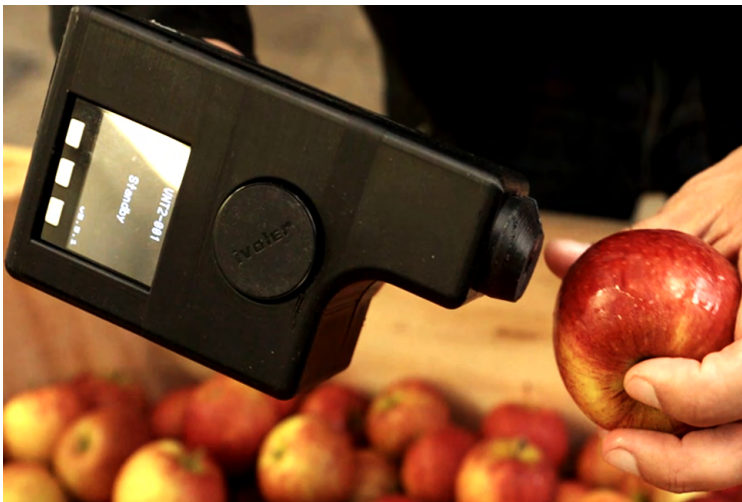
Abbildung 3: (links) Foto des VNT Handspektrometers während der Warenprüfung. (rechts) Beispielhafte Darstellung der mit dem Gerät aufgenommenen Spektren. Dank KI kann aus den scheinbar geringen Unterschieden auf die relevanten Qualitätsparameter zurückgeschlossen werden.
