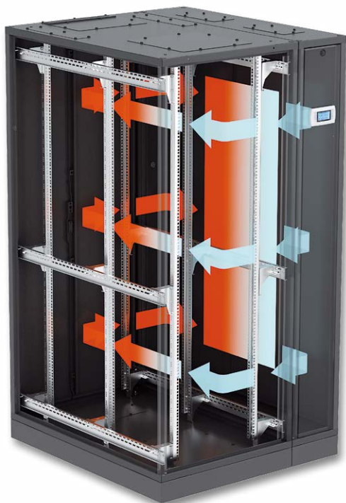
Obieg zamknięty - chłodzenie za pomocą bocznych wymienników ciepła
