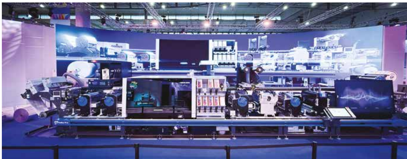
Die neue Gallus Five ist eine leistungsstarke, vollständig integrierte Lösung, die digitale und konventionelle Technologie vereint und industrielle Produktionsgeschwindigkeiten von bis zu 100 Meter pro Minute erreicht.
