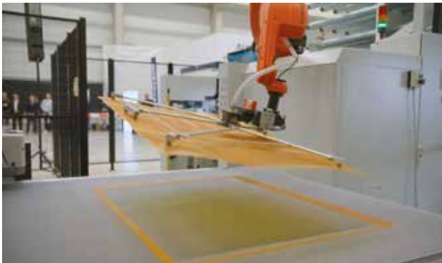
Allstein-Robotik übergibt die zugeschnittenen Platten an die automatisierte Montage.
