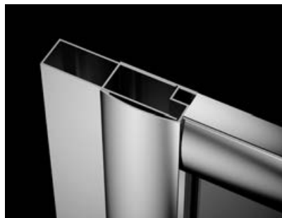
Premium Plus A, C, D, E, P – профиль +4 см. Стандартный U-образный профиль заменяется расширительным профилем P01-127190001.
