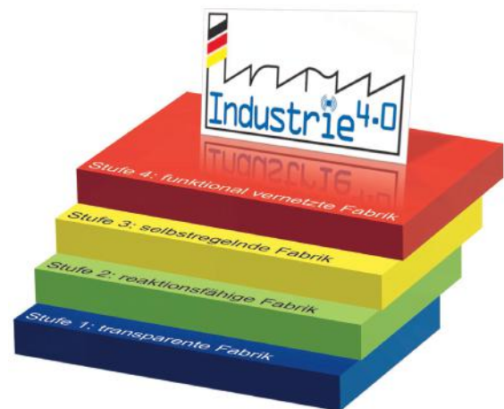
Bild 1: Vier-Stufen-Modell „Smart Factory“ von MPDV
