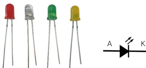
(ก) ไดโอดเปล่งแสงสีต่าง ๆ (ข) สัญลักษณ์ของไดโอดเปล่งแสง
