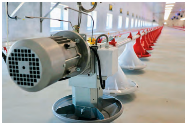
▲ Automatyzacja podawania karmy na fermach produkcji BEST FEEDER z silnikiem BESEL S.A. – Cantoni Group
