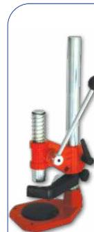
Tappatrice da banco professionale perfetta per l'appassionato esigente. Regolabile in altezza tramite leva per varie tipologie di bottiglie. La testata è in alluminio leggero trafilato in acciaio, la base è in ghisa verniciata. Fornita con boccole per tappo a corona da Ø 26 e Ø 29.
