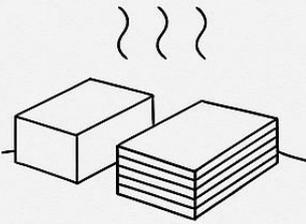
2. Aclimata el material. Deja las cajas cerradas en el lugar de instalación 24 a 48 horas antes. Esto ayuda a que el piso se adapte a la temperatura y humedad del espacio.
