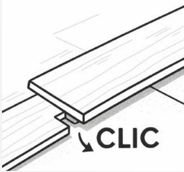
6. Ensambla fila por fila, Encaja las losetas en ángulo y baja para hacer clic, Usa martillo de goma y bloque para asegurar las uniones, Alterna los cortes entre filas para dar más estabilidad visual y estructural.
