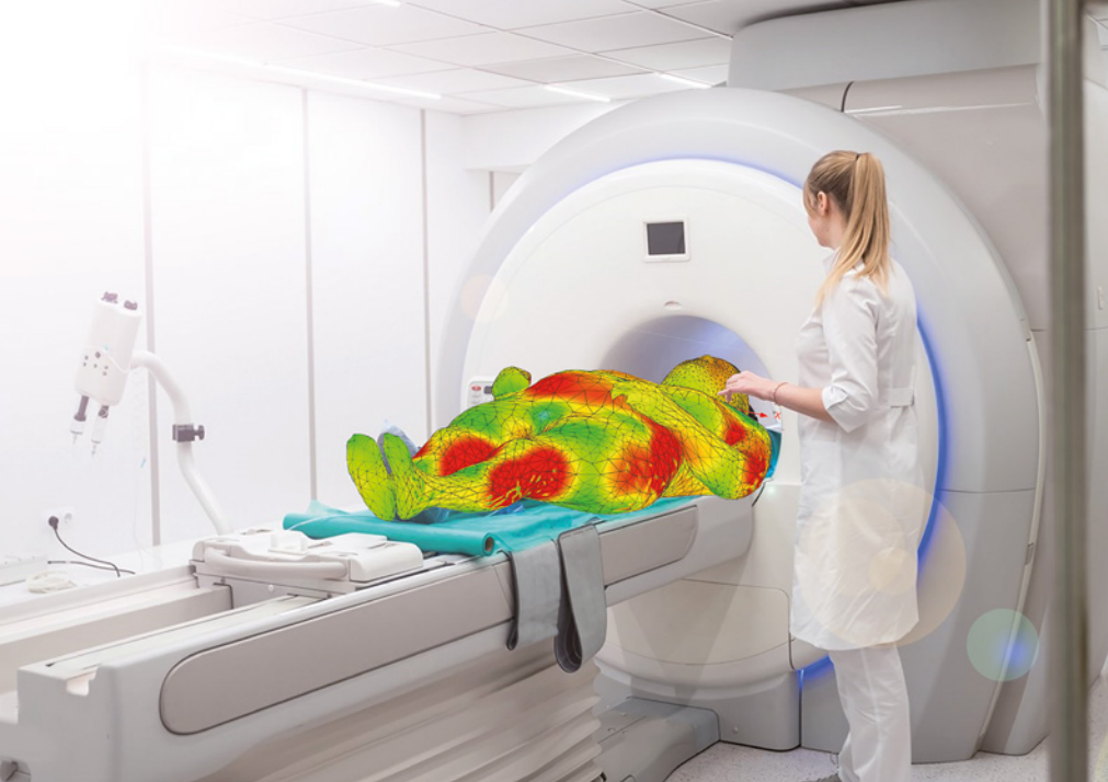
Simulation eines virtuellen Patienten: Risiken, wie Erwärmung von Implantaten bis hin zu inneren Verbrennungen, können im Vorfeld präzise kalkuliert und Gegenmaßnahmen ergriffen werden. So kann die Untersuchungsmethode auch in Fällen genutzt werden, bei denen es bislang wegen der Risiken nicht vertretbar war. Bild: Cadferm Germany
