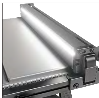
Luce LED integrata nella battuta parallela per un'illuminazione ottimale dell'area di lavoro. Ricaricabile con USB-C
