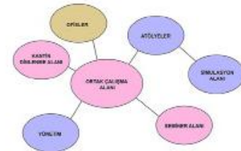
3) Arazi üzerinde birimler birleştikten sonra mekanlar arası ilişkileri görmek için balon diyagram çözüldü.
