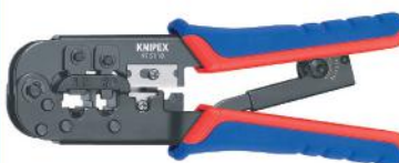
ALICATE PRENSATERMINALES TIPO "WESTERN" RJ 11/12/45 9710682 Proceso de entallaje de gran exactitud, gracias al avance paralelo de las mordazas; con sistema de bloqueo; con dispositivo adicional para pelar cables redondos. 33'02 + IVA = 39'95
